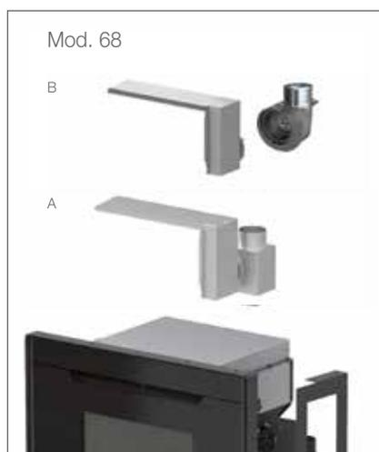
Synthesis Modular est canalisable dans toutes ses déclinaisons. Possibilité de canaliser 1 ou 2 gaines (2 gaines sur synthesis modular 80), sans ventilateur additionnel ou 1 gaine gauche sans ventilateur et une gaine droite avec ventilateur additionnel 170 m<sup>3</sup>/h.
